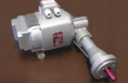
Moteur muni d'un frein à disque et d'une dynamo tachymétrique
