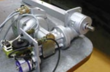
Motoréducteur de conception spéciale avec fin de course, potentiomètre de recopie et multiplicateur, le tout montés sur vanne
