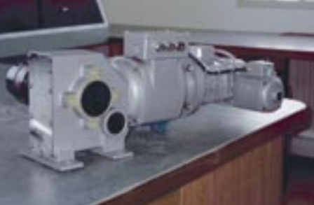
Ensemble motoréducteurs à 3 vitesses avec embrayage
